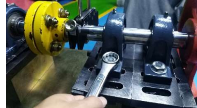
Gambar 3.6 Mengencangkan baut dudukan
